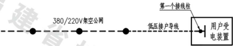
图B.9 低压用户由架空公网绝缘导线接入
